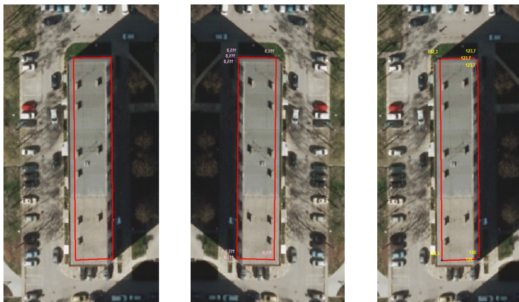
Slika 5. Prikaz postupka analize podataka o visinama za poligonski objekt zgrade
